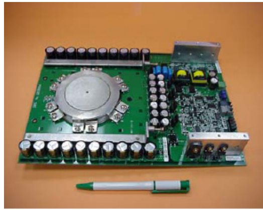
Fig. 4.6. 6500-V/1500-A symmetrical GCT [6].
