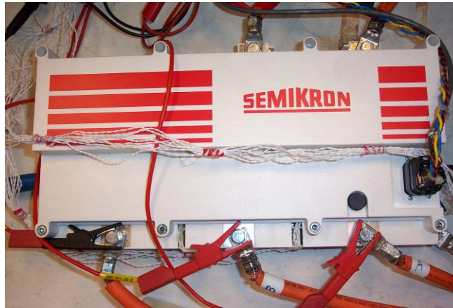
Fig. 3.13. Semikron inverter unit.
