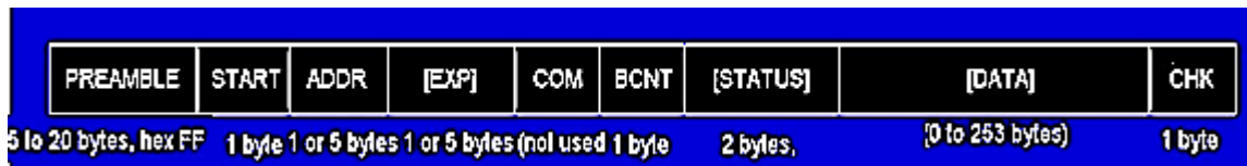
Fig 1.29: A HART message frame
