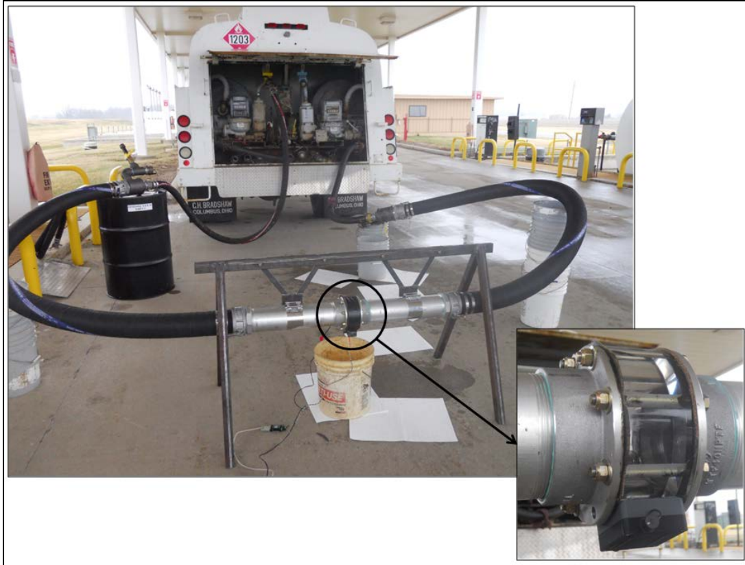
Fig. 78. Fuel loop test rig.
