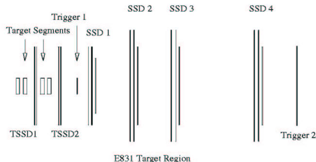
Figura 3.3: Diagrama de la región del blanco. Se muestran los blancos de BeO, los planos de silicón intercalados dentro del blanco y los planos de silicón después del blanco, y hodóscopos del trigger . La dirección del haz es de izquierda a derecha.
