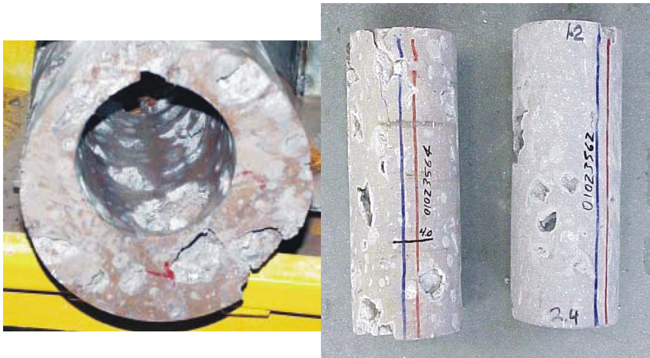
Figure 6.3-7. Large (305 mm) Diameter Cores from Ttpul and Ttpll Units
