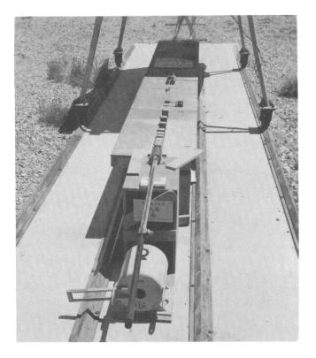
Fig. D.1-Co<sup>60</sup> gamma calibration system.
