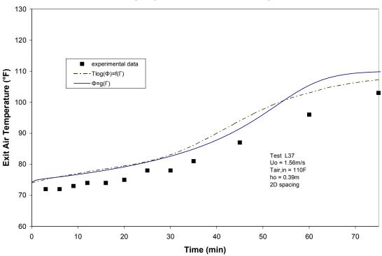
**TEST #37 - EXIT AIR TEMPERATURE**
