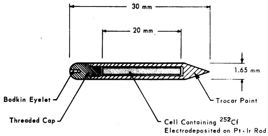
FIG. 1  $^{252}\text{Cf}$  NEEDLE
