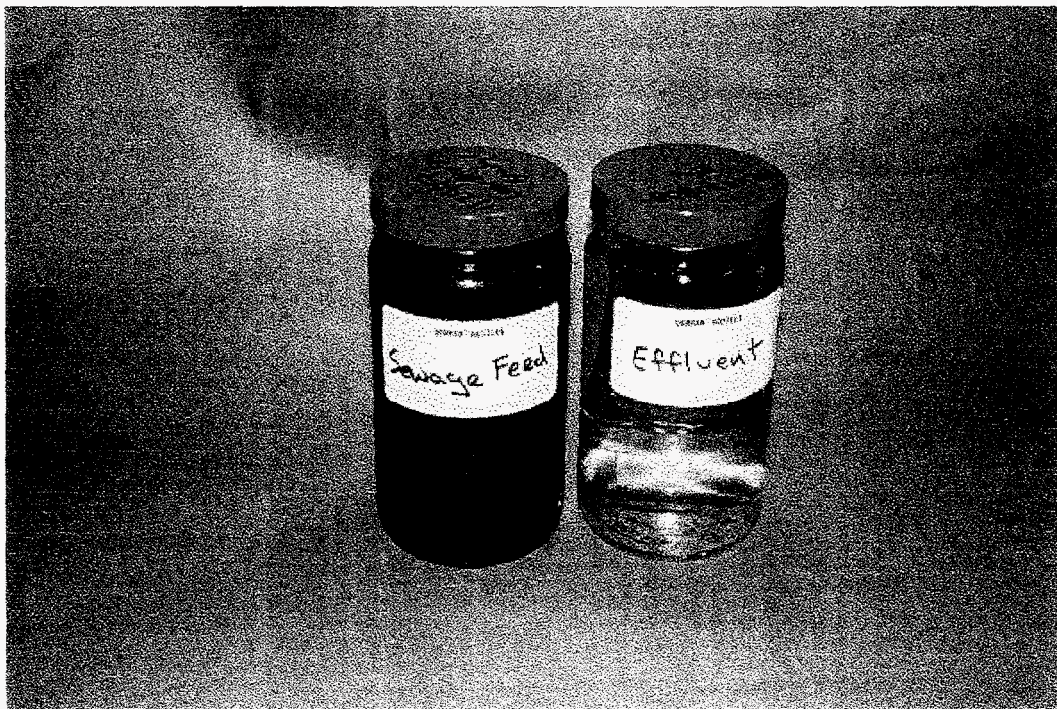
Fig. 3-2. Biosolids feed and SCWG effluent
