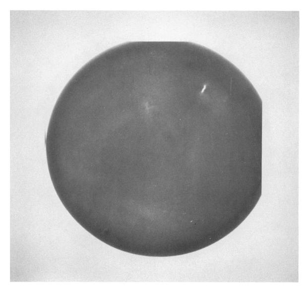
Figure C-8. DISC 505 AFTER 375° F IMPACTION AT 2.4 X 10<sup>5</sup> PSI.
