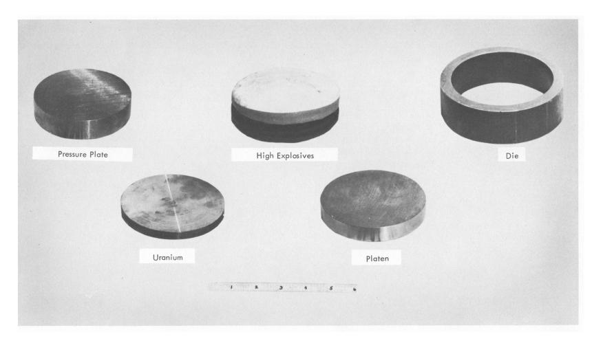
Figure A-3. COMPONENTS FOR EXPLOSIVE TEST.
